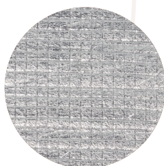
FR-Type / 30 kg densità / 15 mm + strato adesivo / film riflettente metallizzato Serbatoi acqua refrigerata
